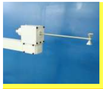
ギヤBOXを取付けることで、水平方向の偏波切 換が可能
