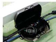
OPT387 光中継コネクタBOX 光ケーブルの連結、 保護ができます。
