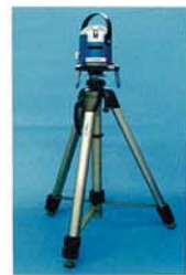
AE00-18 レーザー中心位置合わせ治具 ポジションナやアンテナなどの 設置位置の確認に最適です。
