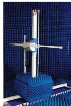
オプション(OPT397) 電波吸収体(駆動部用) 取り付け例
