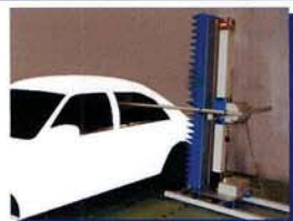
■ アーム部(Z軸部)を車内に入れて測定できる
